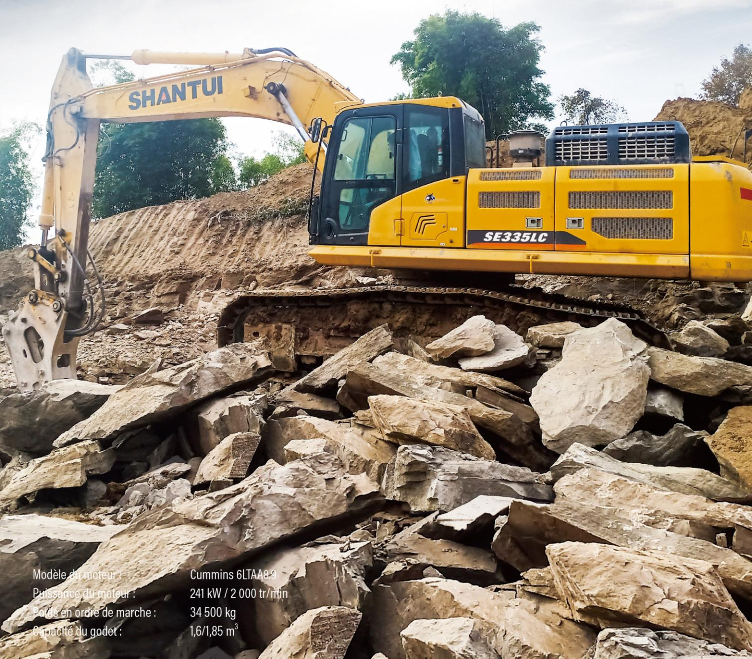
Modèle du moteur : Cummins 6LTAA8.9
